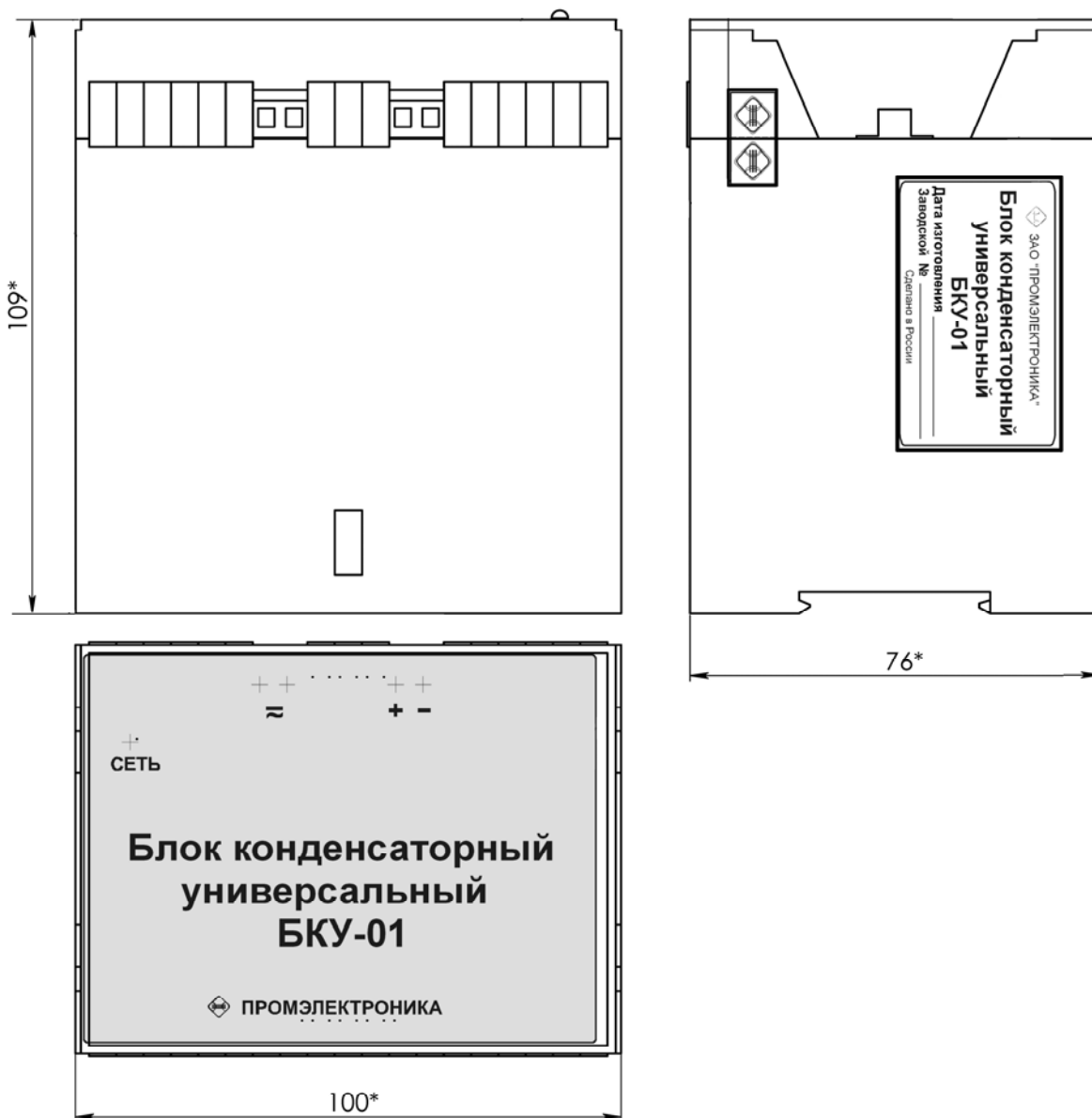
Рисунок Г.10 – Габаритные размеры БКУ-01
